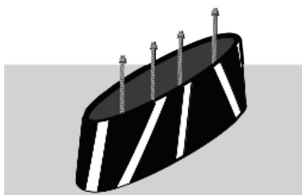
Figure 5 – Insérer les tiges filetées dans les trous préalablement remplis de résine, tout en les faisant tourner, afin que le pas de vis se remplisse de résine. Une fois que la résine a durci, ajuster les écrous.
