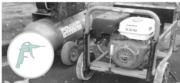
2. COMPRESSEUR D'AIR POUR ÉLIMINER LA POUSSIÈRE DES ORIFICES ET ASPIRATEUR POUR ÉVITER LA DISPERSION DE LA POUSSIÈRE DANS L'AIR.
