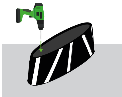
Figure 1 – Placer les modules et marquer les trous sur le sol.
