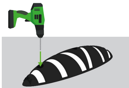
Figure 1 – Placer les modules et marquer les trous sur le sol.
