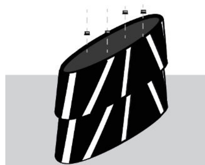
Figure 7 - Installer la seconde jardinière par-dessus la première. Serrer les derniers écrous avec la clé à douille.
